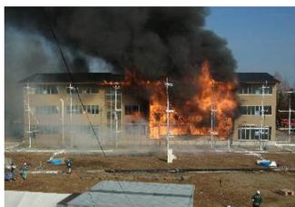
木造3階建て校舎の実大火災実験
