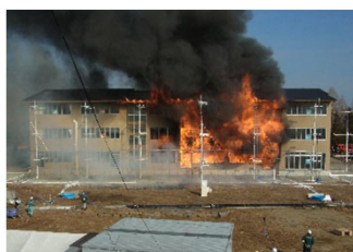
木造3階建て校舎の実大火災実験
