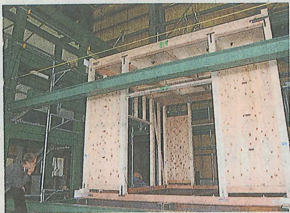
大地震を想定した大きな揺れに間伐材が耐えられるか確認する実験の様子 15日午前10時34分、京都市宇治市の京大防災研究所(板東和正撮影)
