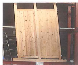
(財)日本建築総合試験所 「耐力壁の面内せん断実験」
